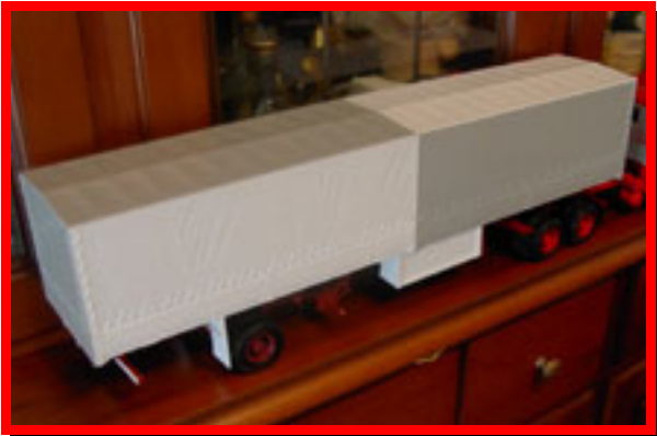
Il telaio e’ saldato alla centina con l’Attack, ora e’ pronto per ricevere la prima mano di fondo (semirimorchio 2 assi centinato Frhueauf) .
